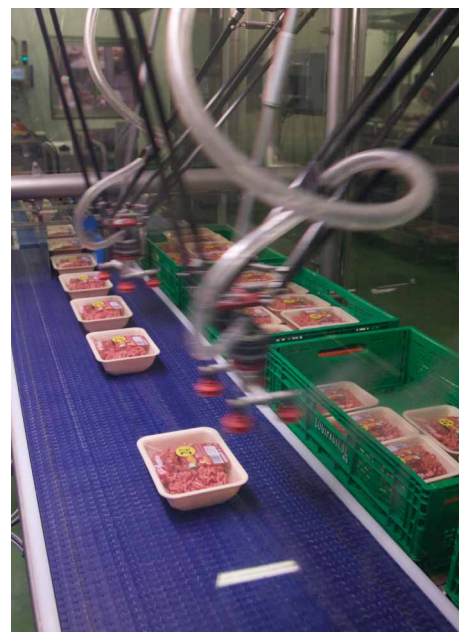
Een van de drie IPS pick&place systemen van Ishida. Ishida's Solutions Team heeft de software speciaal aangepast om aan alle vereisten van Martínez te voldoen.
